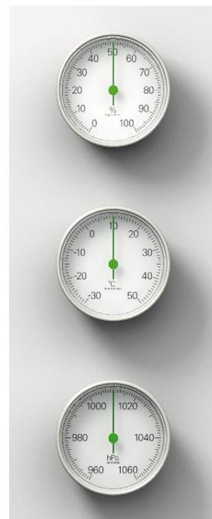
**CHE TEMPO CHE FA/** Meteo di Naoto Fukasawa per Magis è uno strumento che integra le funzioni di igrometro (per misurare l'umidità relativa nell'aria), barometro (per misurare la pressione atmosferica) e termometro. € 204. [www.magisdesign.com](http://www.magisdesign.com)
